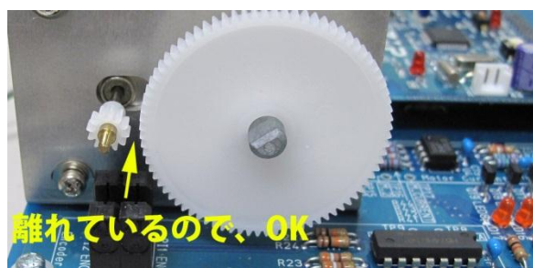
図7 ポテンシオメータのダイヤルと DC モータの回転軸歯車との関係
