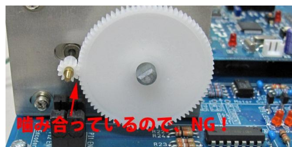
図7 ポテンシオメータのダイヤルと DC モータの回転軸歯車との関係
